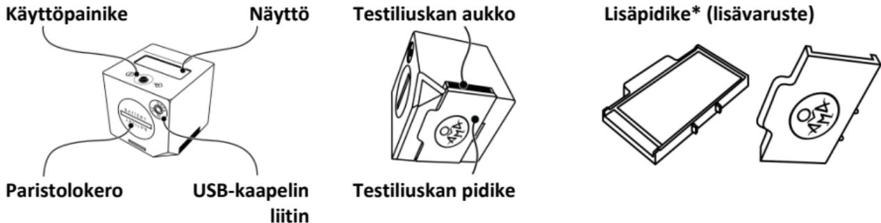
Lukulaite toimii paristoilla (3 kpl, 3V CR2032) tai verkkopistokkeesta **USB-adapterin** kautta\* (lisävaruste, 5V, 500 mA) sekä laitteelle tarkoitettun **USB-kaapelin** kautta\* (lisävaruste).
