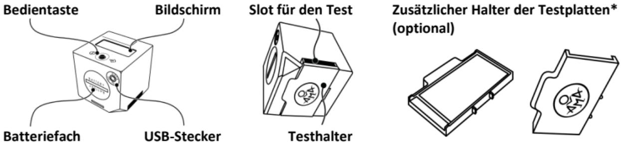
Der AMA RUT Reader kann mit Batterien (3 St., 3V CR2032) oder mit Strom vom Netz, via **Wechselstromadapter\*** (optional, Ausgang 5 V, 500 mA) und **dem speziellen USB-Kabel\*** (optional), arbeiten.
