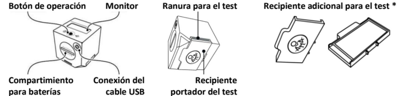
El Lector se puede alimentar por baterías (3 unidades, 3V CR2032) o mediante la red a través **del adaptador USB AC/DC\*** (salida 5V, 500 mA) y **un cable USB especial\***.
